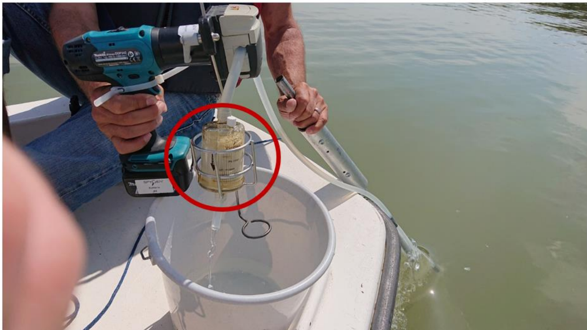
Figure 3 : capsule de filtration (cercle rouge) pour l'échantillonnage de l'ADNe. L'eau s'écoule dans le sens des flèches noires (© BOKU, P. Meulenbroek).
