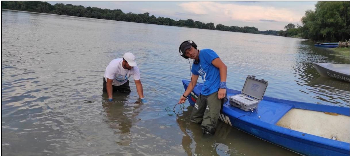
**Figure 13 :** *Contrôle du fonctionnement d'une marque acoustique à l'aide d'un récepteur mobile avant la remise en liberté d'un esturgeon marqué (© WWF-Bulgarie).*
