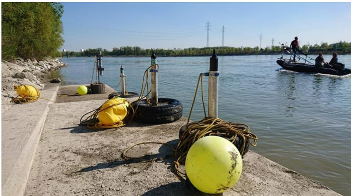
**Figure 14 :** Hydrophones en attente d'être paramétrés avant d'être déployés en tant que réseau de récepteurs, sur la rive en aval de la centrale hydroélectrique de Freudenau (© IHG/BOKU).
