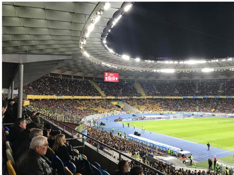
Photo 12 - Filet de séparation à côté de vomitoires compromettant la capacité de sortie (d'urgence)
