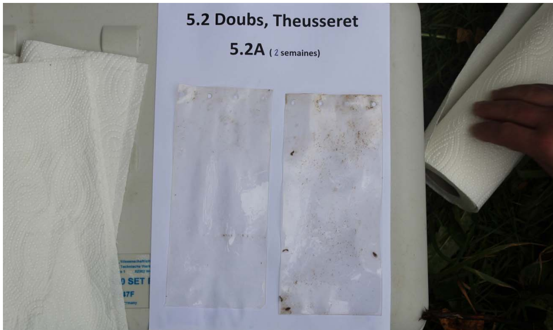
Etat des capteurs après 2 semaines
