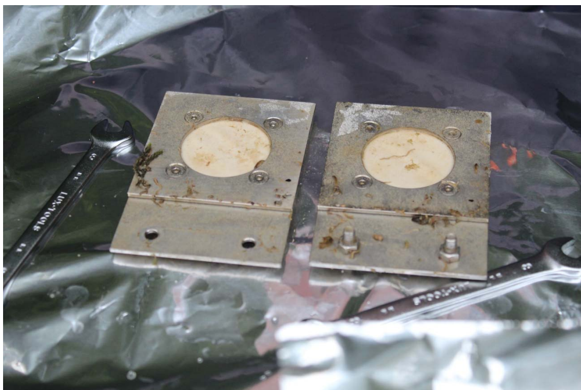
Les capteurs sont légèrement colonisés par des bactéries et des petits vers.
