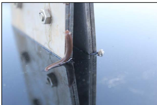
Etat des capteurs après 21 jours d'exposition
