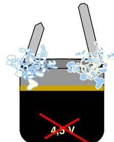
La tension aux bornes d'une pile usée est nulle ou très faible.
