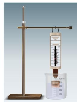
Figure 8.4 : Principe d'Archimède<sup>69</sup>.
