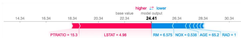
Abbildung 5. Beispiel für eine Erklärung auf der Grundlage der Merkmalbedeutung durch SHAP
