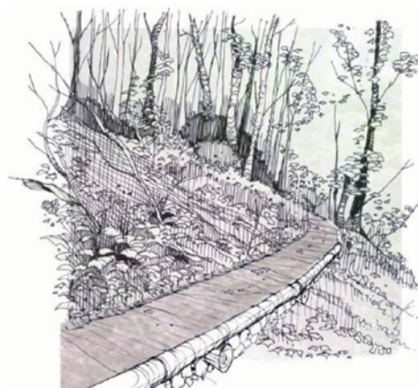
Apertura di un nuovo sentiero – Opere di sostegno della sede realizzate mediante tecniche di ingegneria naturalistica.
