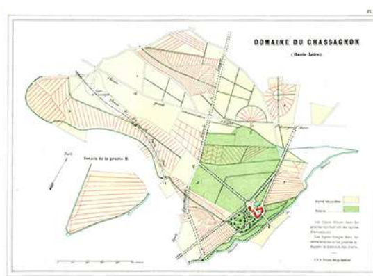
Fig. 60. Plan du système de drainage et d'irrigation (en rouge) d'une ferme ayant obtenu la prime d'honneur en Haute-Loire en 1857, France. (Photo CMRSH Caen, fonds ancien du ministère de l'Agriculture)
