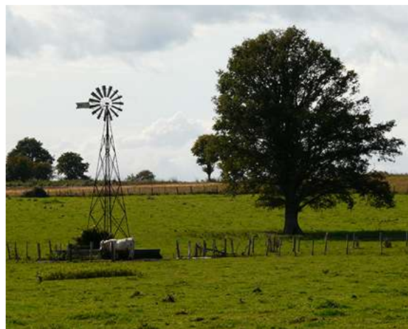
Fig. 25. Petite éolienne pour remonter l'eau de la nappe phréatique. (Photo F. Bonneaud)
