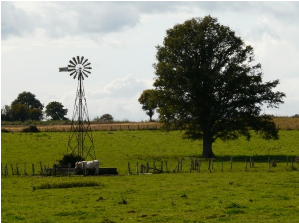
Petite éolienne pour remonter l'eau de la nappe phréatique
