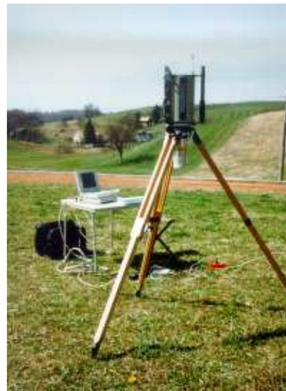
Pour mesurer l'exposition externe due à un nuage radioactif ou une surface contaminée, des instruments de mesure du débit de dose ou de la dose sont utilisés. Pour évaluer l'exposition interne, il faut
