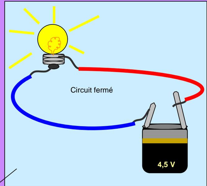
Le circuit électrique n'est pas coupé. Il est fermé. L'ampoule est alimentée. Elle éclaire.
