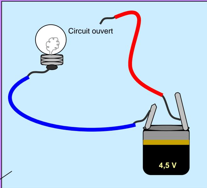
Le chemin par lequel le courant électrique circule est coupé. Si le circuit électrique est coupé (ouvert), l'ampoule n'est pas alimentée. Elle est éteinte.
