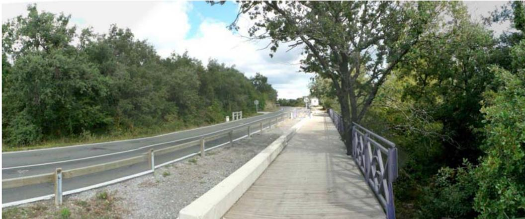
*Fig. 50. Piste cyclable à longéant la route. Piétons et cyclistes sont séparés de la circulation par un mur bas et une glissière de sécurité.*
