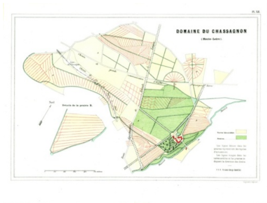
Plan du système de drainage et d'irrigation (en rouge) d'une ferme ayant obtenu la prime d'honneur en Haute-Loire en 1857, France
